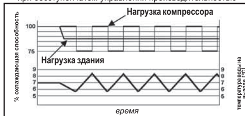
Изменение ELWT (температура воды на выходе испарителя) в зависимости от выбранного значения производительности (4 значения)
