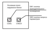
Для запуска режима принудительного охлаждения следует один раз нажать кнопку.
